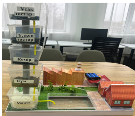
Сурет 1 – «Aqua Clean» жобасы: Arduino арқылы басқарылатын су сүзгілеу құрылғысының макеті
